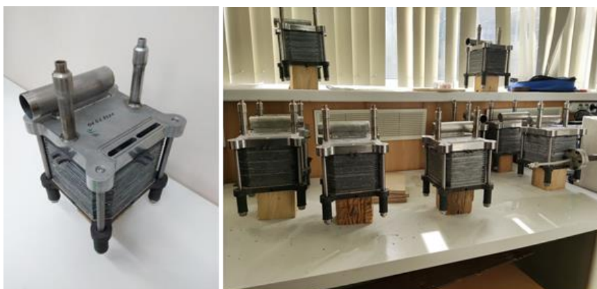
Рисунок 1 - Фотографии стеков с ТОТЭ планарной геометрии на несущем электролите.
